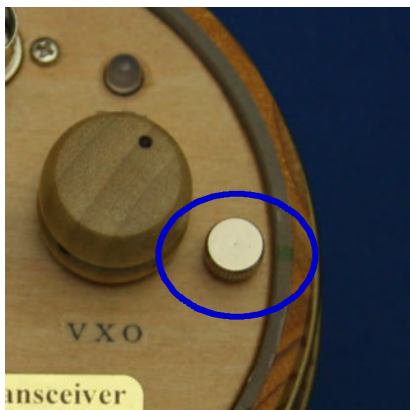
内部にアクセスするためのネジ
