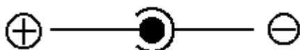
外部電源アダプタの接続(+が内側) DC-9V(付属コードの赤が+、黒が-)
