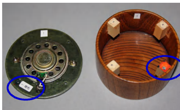
外部スピーカー (橙色のネジの位置を示している)
