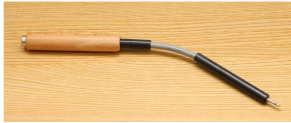
写真－5 木管とプラスチック棒を利用して作成したマイク
