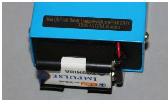
ニッケル水素電池を取り付けた状態
