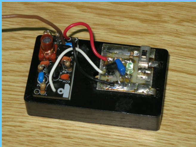
外観の様子：単3電池ボックスの上にメロディICとFM送信機の回路を貼り付けています。 大きさ56mm(横)×32mm(縦)×35mm(高さ)
