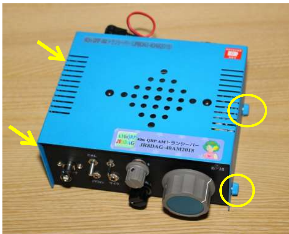
横の○印のねじ(4カ所)をはずします
