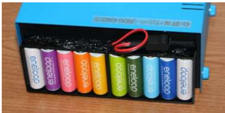
図-6 電池ケースを外付 (マジックテープを利用)
