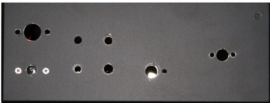
写真-3 ケースの穴あけの様子(すべて丸穴としている)
