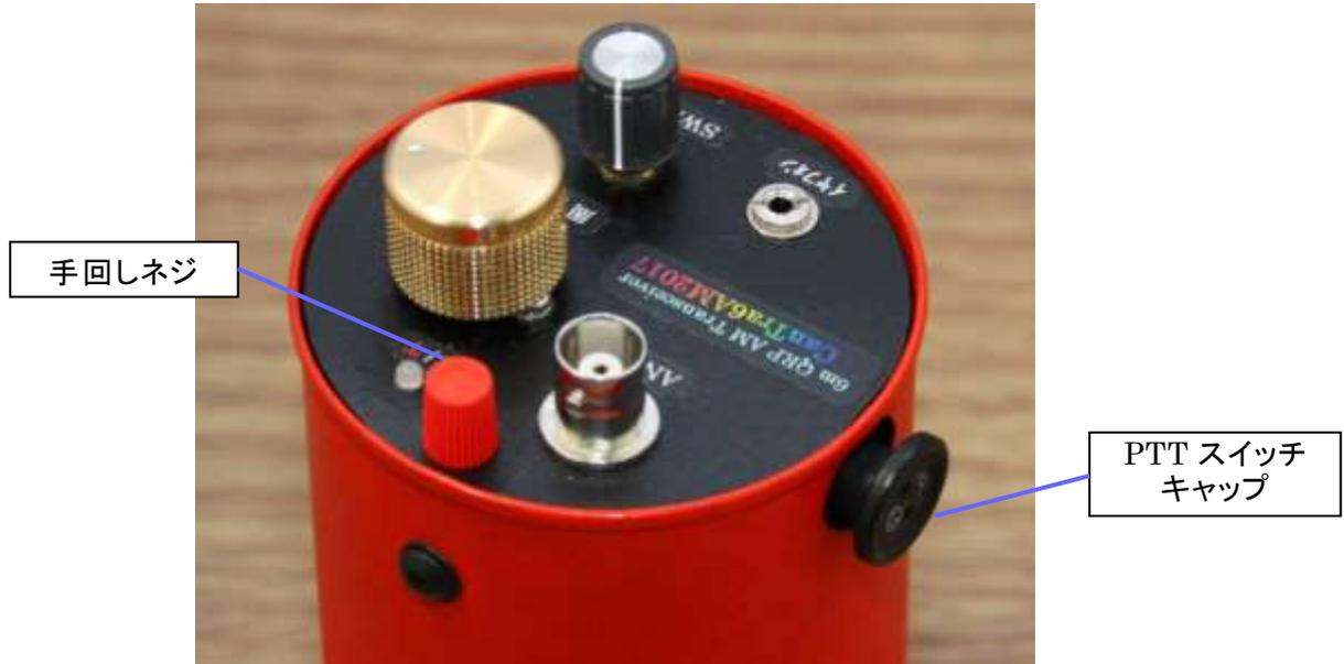
図-15 手回しネジと PTT スイッチキャップ
