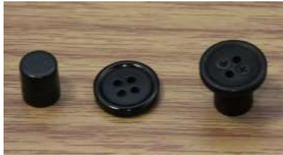
図-12 PTT スイッチキャップの加工
