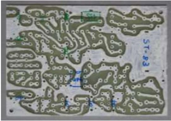
図-7 作成した基板
