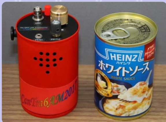
空き缶を利用した 6m QRP AM トランシーバー (CanTra6AM2017)
